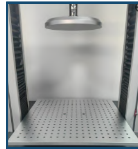
JG 25014 Foam Compression ISO 2439 Upper Platen: D7.9x0.79" Lower Platen: 15x15x0.4"
